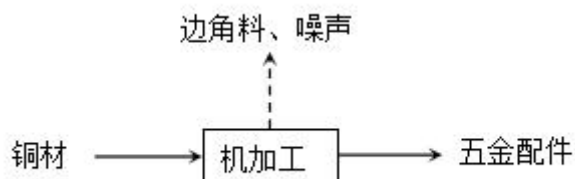
图 2.2-3 五金配件生产工艺流程及产污环节
